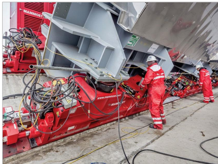
▼ Перемещение блока корабля. Масса – 3 000 тонн
