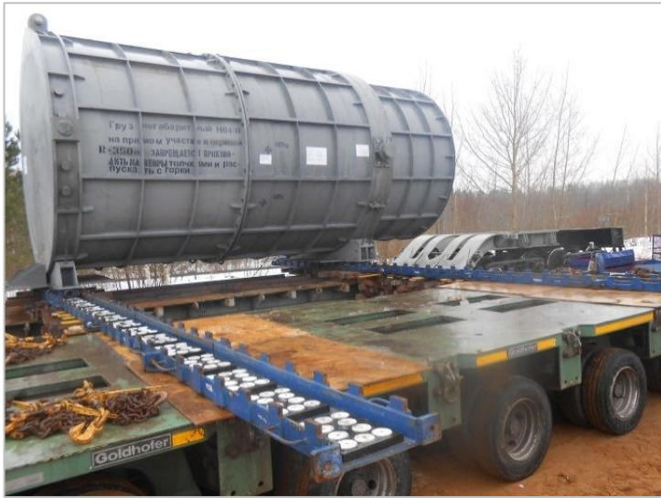
▲ Перегрузка турбины с автотрейлера на ж/д транспортер. Масса - 100 тонн
