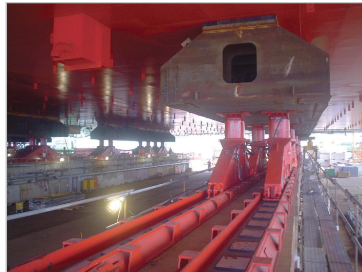
▼ Перемещение блока корабля. Масса – 3 000 тонн
