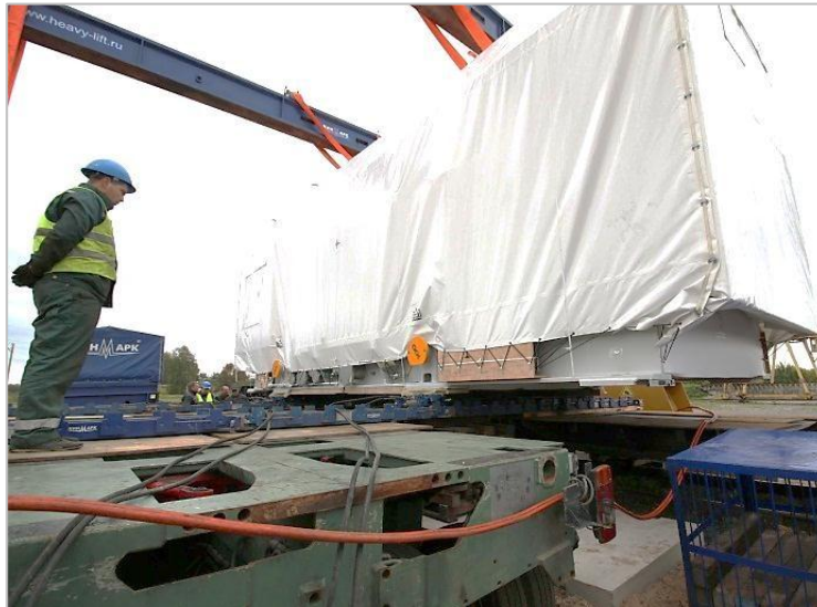
▲ Перегрузка турбины с автотрейлера на ж/д транспортер. Масса - 100 тонн
